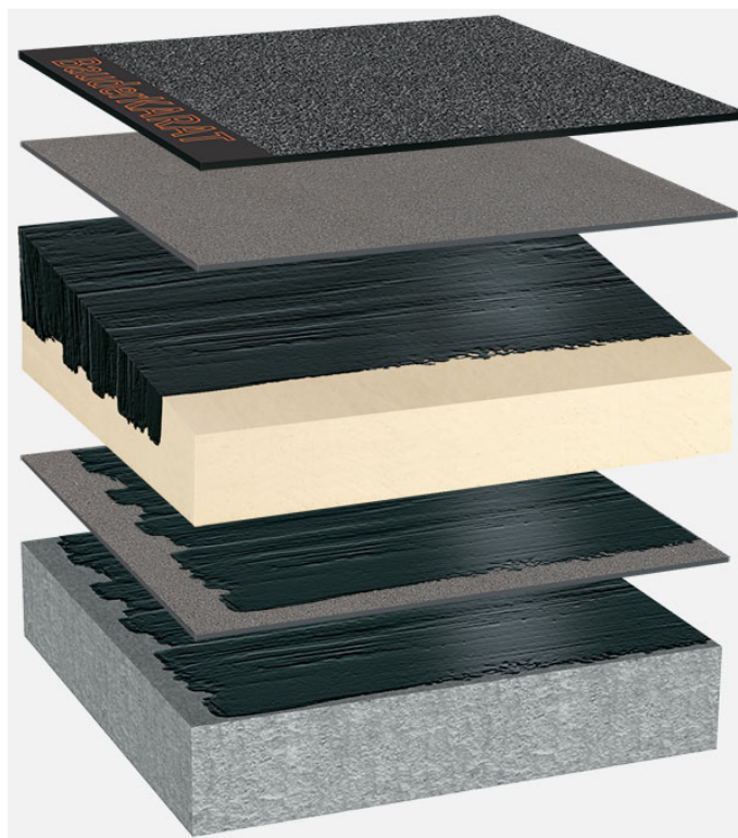
Systemowy układ warstw: BP_PIR-KG_K_01
