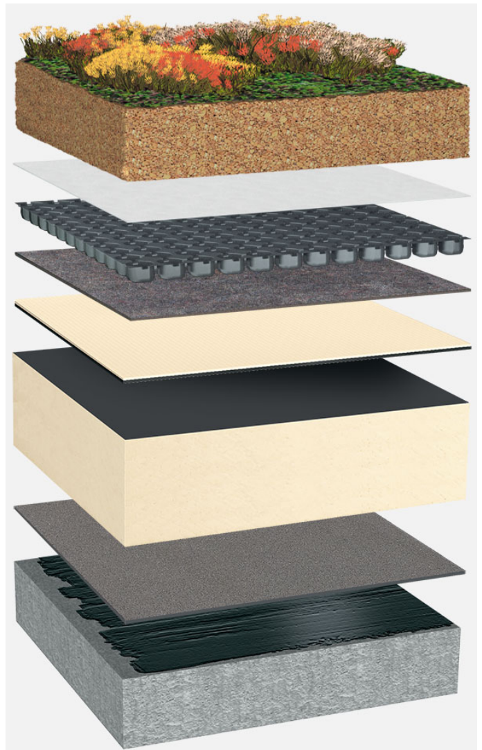
Systemowy układ warstw: BG_PIR-FA_T_01_G125
